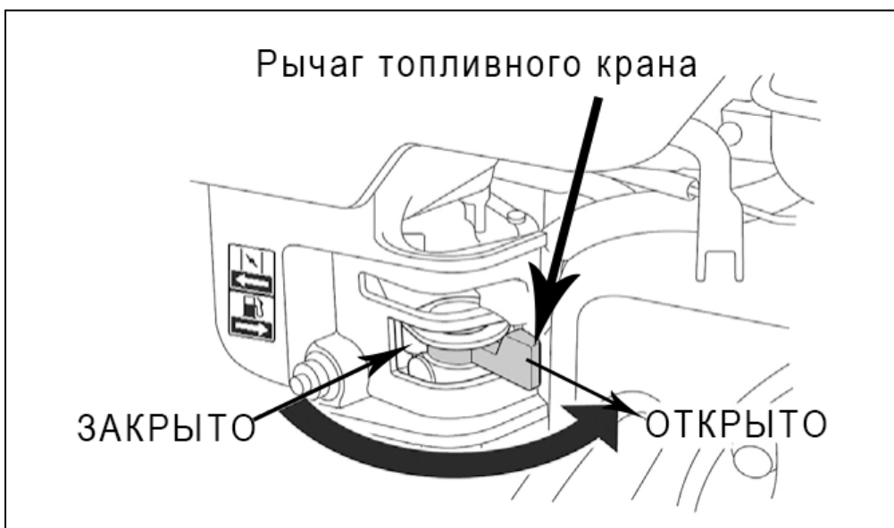
Рис. 11. Рычаг топливного крана.
