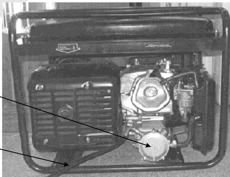
**Примечание:** На моделях генераторов DY5000 и DY6500 возможно использование на обоих видах топлива (бензин **или** газ), что может облегчить пуск генератора в зимнее время года.
